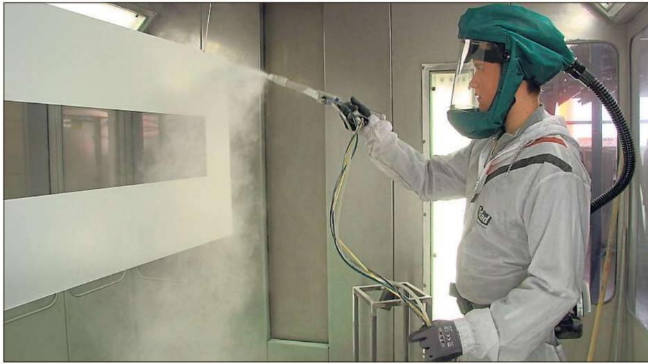
Geschützt mit Maske und Anzug trägt Finn Gellermann eine Pulverschicht auf ein Blech auf. Der 18-jährige Sünninghausener macht eine Ausbildung zum Verfahrenstechniker für Beschichtungstechnik bei Unternehmen Obuk Haustürfüllungen in Oelde. Bilder: Junker
