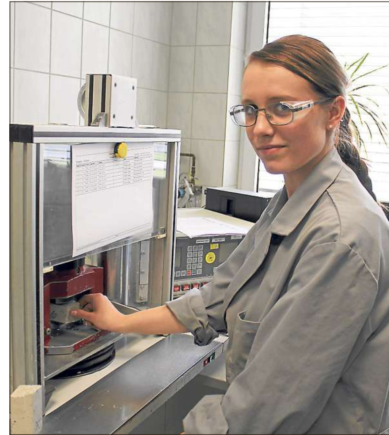
Mit einem Messgerät prüft Melanie Alex die Biege- und Bruchfestigkeit eines Prüfkörpers. Jedes Produkt, das Heidelberg Cement in Ennigerloh verlässt, wird vor dem Verkauf ausgiebig getestet.
